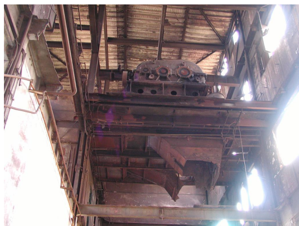
vnitřek PS 5 s pozůstatky pásových pohonů
